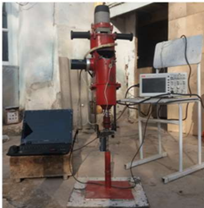
Рисунок 2. Экспериментальный стенд для исследования динамики электромеханического перфоратора
